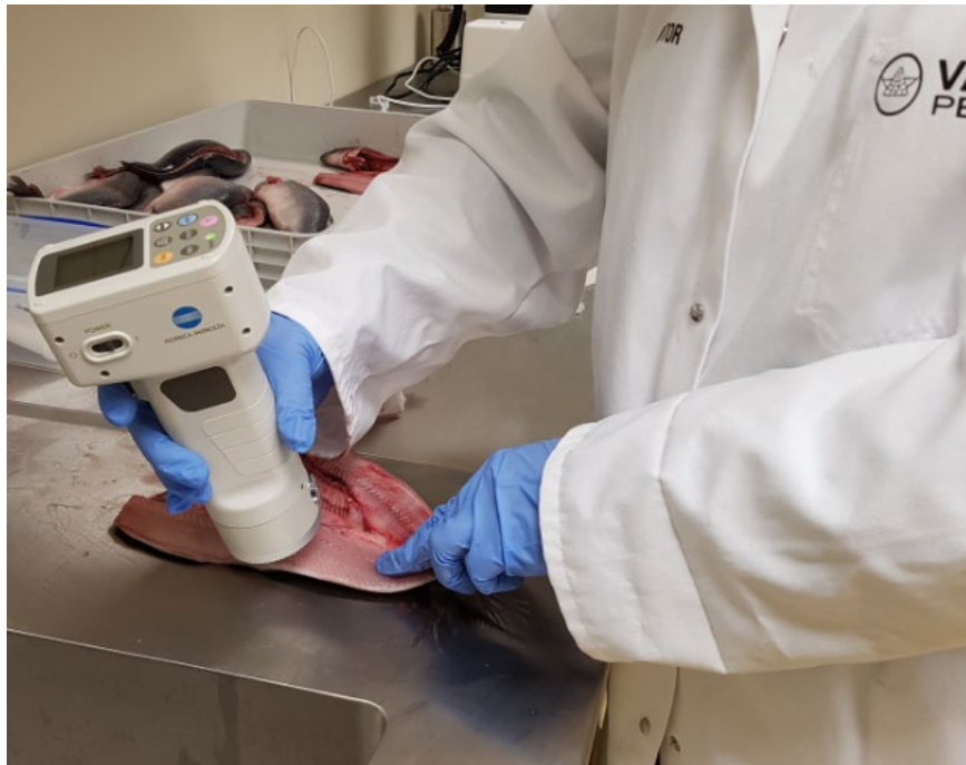
Mynd 6 Myndin vísir, hvussu litmáting av fiskamusklinum verður gjørd. Her verður mált á sild
