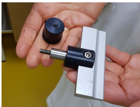
Mynd 21 T.V.: Standard 90 mm proba. T.H.: serliga tilgjørd proba á 45 mm, bíløgð frá Stable Microsystems. Tað vísti seg seinni, at ein forleingjari má til probuna, tí hæddin kann ikki kalibrerast rætt.
