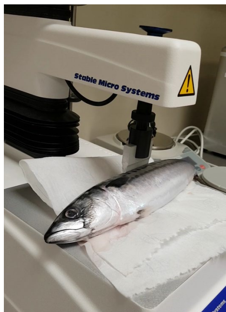
Mynd 22 Tillagaða metodan leggur upp til at gera tvær mátingar per fisk. 1 eftir rygginum og 1 eftir brúkinum. Ein forleingjari má tó til probuna, so hæddin niður á plattformin kann kalibrerast rætt.
