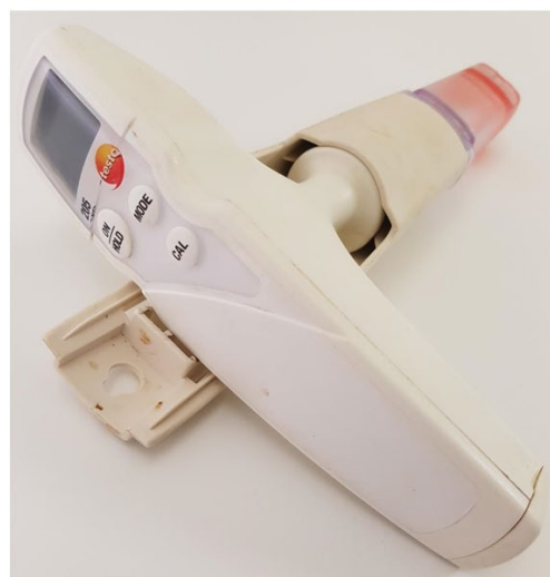
Mynd 17 Handhildin tól til at máta blóðlaktat, Lactate Pro 2 (t.v.) og muskul pH, Testo 205 (t.h.).
