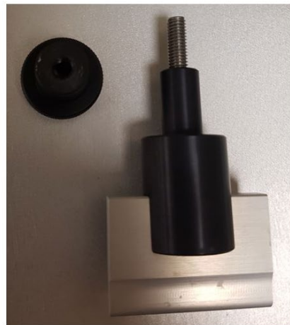
Mynd 21 T.V.: Standard 90 mm proba. T.H.: serliga tilgjørd proba á 45 mm, bíløgð frá Stable Microsystems. Tað vísti seg seinni, at ein forleingjari má til probuna, tí hæddin kann ikki kalibrerast rætt.
