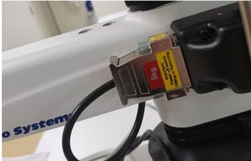
Mynd 23 Bæði kanningtólini hjá Varðin Pelagic hava eina "load cell" á 5 Kg. Hetta vísti seg ikki at vera nokk tá tillagaða proban varð nýtt orsaka av "overload". Ein 10 Kg cella má skaffast.
